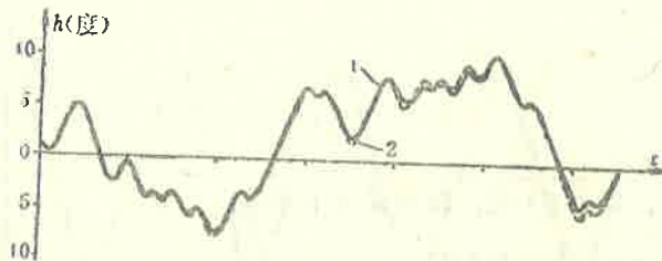
图 3 随机航行试验曲线 1——实际记录曲线; 2——一阶 K-T 方程拟合曲线
