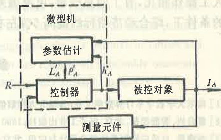
图 4 自适应控制器结构
