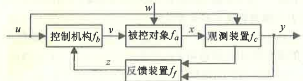
图 1 控制系统方框图 Fig. 1 Block diagram of control system
