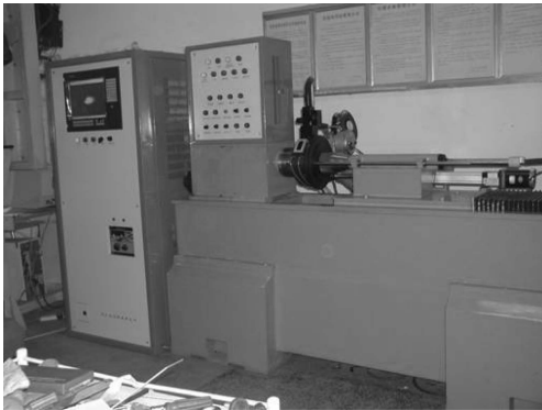
图4 数字控制薄壁筒体自动焊接系统
