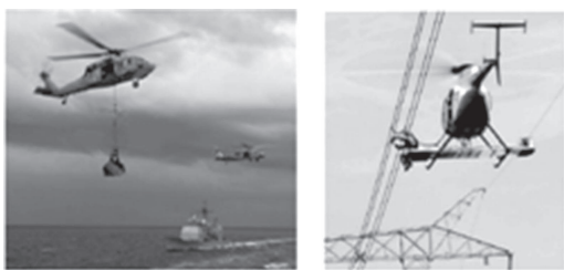
图 2 利用直升机进行舰船间物资补给及输电线路带电环境作业
