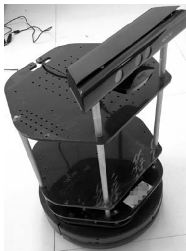
图2 搭载Kinect的TurtleBot 2机器人 Fig. 2 TurtleBot 2 loaded with Kinect
