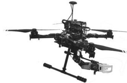
图1 旋翼飞行机械臂系统
