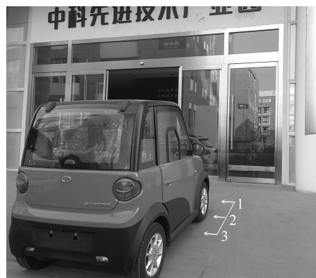
图10 试验车辆及前轮3个轴线初始位置
