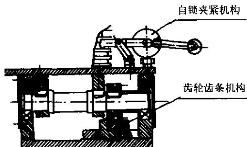
图 2 发动机气缸盖专用夹具
