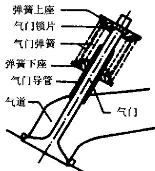
图 1 气门组件结构图
