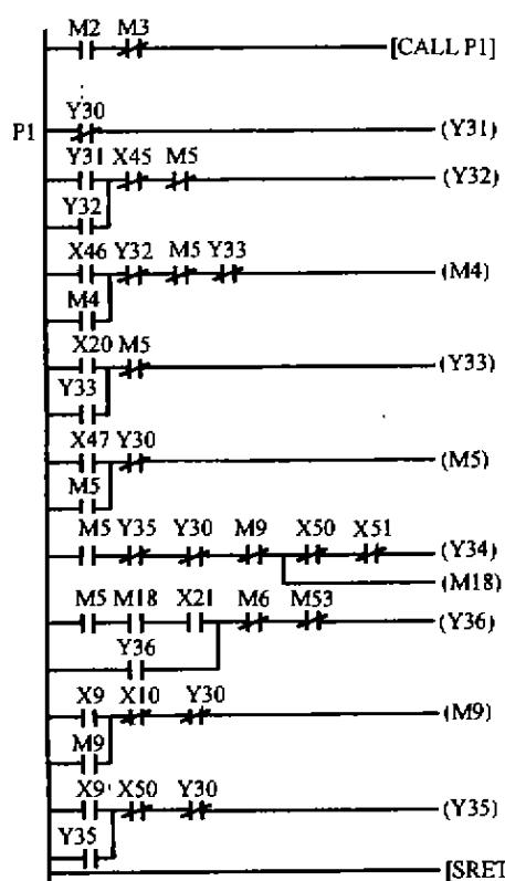
图 6 PLC 与机器人协调工作的梯形图(部分)
