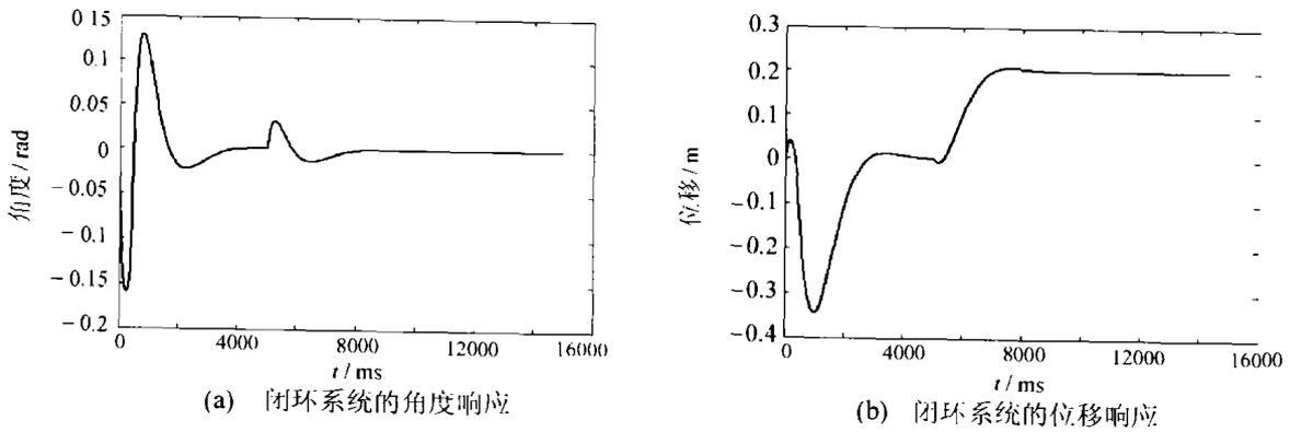
图 2 施加 0.2 m 的位移信号时模型参数不变的仿真结果
