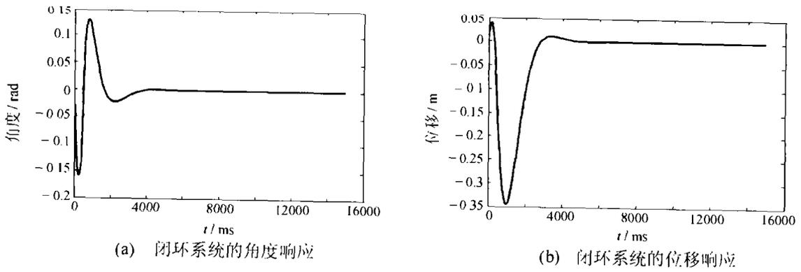
图 1 施加脉冲力时模型参数不变的仿真结果
