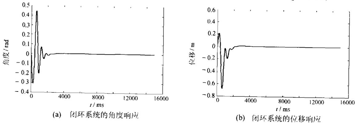
图 3 施加脉冲力时模型参数改变 ( $L = 0.6, b = 0.2$ ) 的仿真结果
