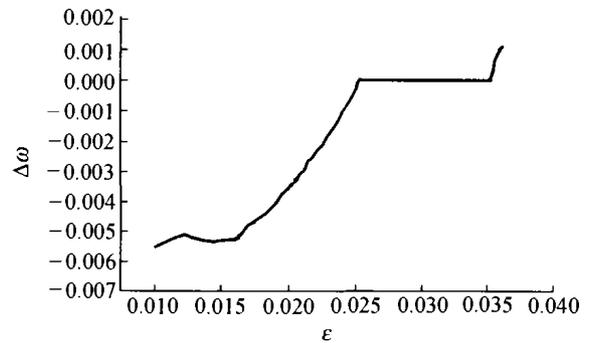
图 1 混沌运动的频率差值  $\Delta\omega = \omega_1 - 2\omega_2$  与  $\epsilon$  的关系
