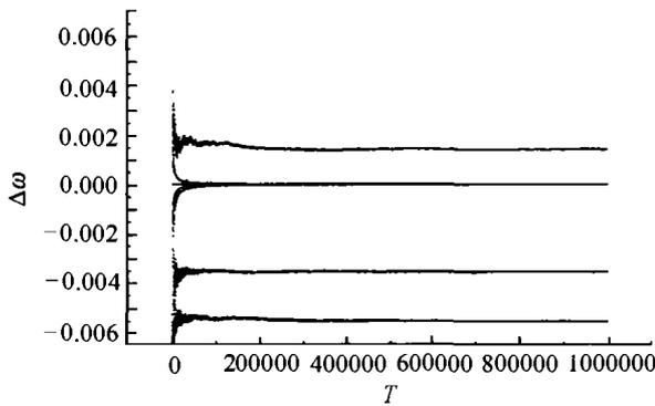
图 4 混沌运动的频率差值  $\Delta\omega = \bar{\omega}_1 - 2\bar{\omega}_2$  与  $T$  的关系
