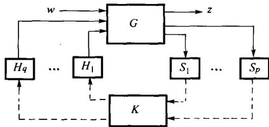
图1 同步多速率采样控制系统
