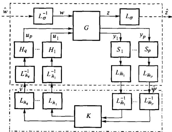
图2 提升同步多速率采样控制系统
