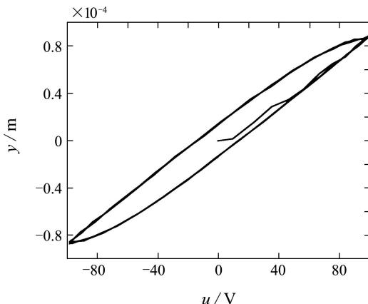
图1 压电迟滞系统输入输出特性
