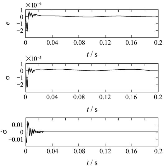
图3 在  $\eta_1(X) = \rho_3 \| X(t) - X(0) \|_2$  情况下的误差和滑模函数收敛曲线
