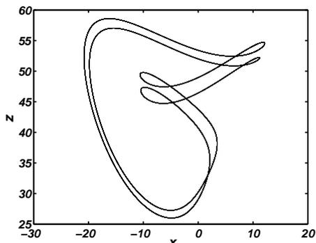
图 6 当参数  $a = 25, b = 1.8, c = 18, e = 30$  时, 系统(2)的 2 周期  $x-z$  平面相图
