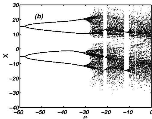
图 7 当参数  $a = 25, b = 1.8, c = 18$ , 改变控制参数  $e$  时, 系统(2)的 (a) Lyapunov 指数谱, (b) 分叉图
