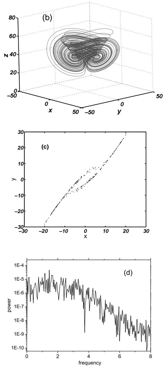
图2 当参数 $a = 25, b = 1.8, c = 18$ 时系统(2)的(a)时序图、(b)相图、(c)Poincaré截面图和(d)功率谱图
