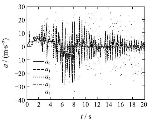
图 5 PID控制器车辆加速度曲线
