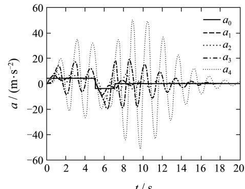
图 9 保性能控制器车辆加速度曲线
