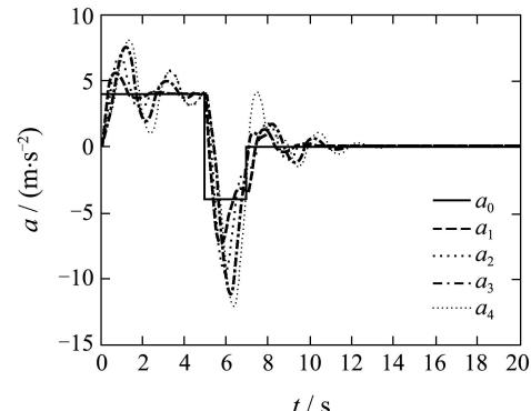
图 7 保性能控制器车辆加速度曲线
