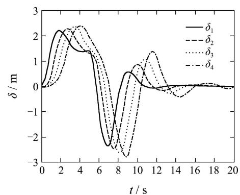
图 4 PID控制器车队车间距离误差曲线
