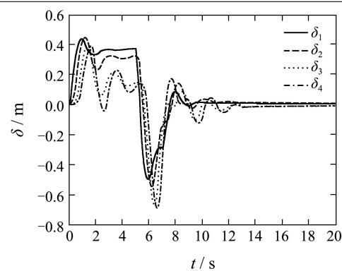
图 6 保性能控制器车队车间距离误差曲线
