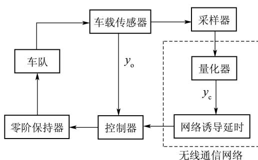
图2 车队网络结构图
