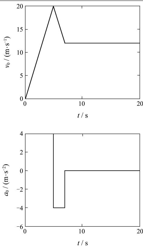
图 3 领队车辆速度、加速度曲线
