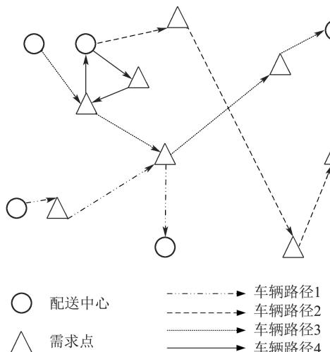
图3 半开放式车辆路径示意图
